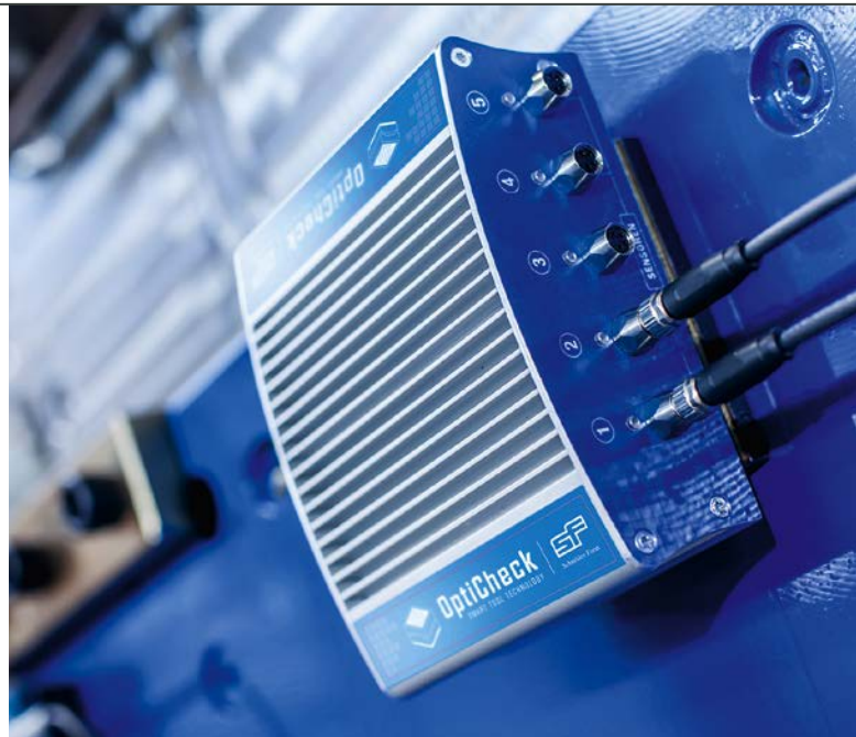
Alles im Kasten: Die OptiCheck-Box sendet die Sensordaten via WLAN an ein Notebook. (© Schneider Form)
