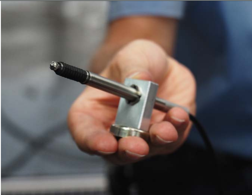
Kleines Ding, große Wirkung: Der in Opticheck verbaute Sensor GT2 von Keyence macht die Bewegungen im Werkzeug und damit die Werkzeugatmung messbar. (© Hanser/Schröder)
